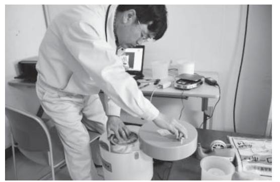
測定機器はNaIシンチレーションスペクトロメーター(購入価格168万円)で、短時間で簡易に測定できる機器です。
