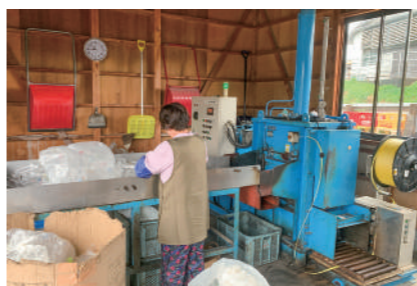
ペットボトルや容器包装プラを圧縮するマルチコンパクタ(リサイクルセンター)
