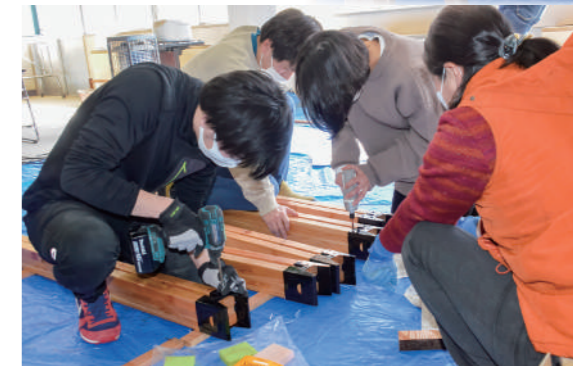
△くずまき高原カラマツの集成材を活用した新しいサイクルラック △2月28日に行われた部会の様子
