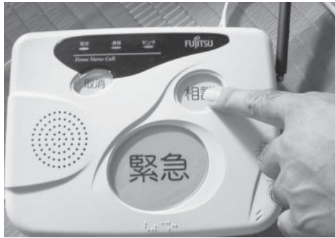
増設する緊急通報装置
