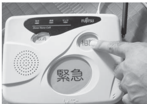
増設する緊急通報装置
