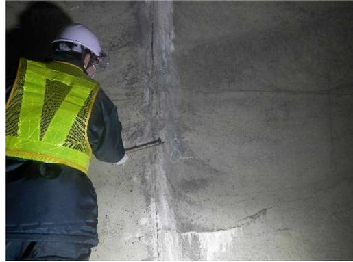
写真-6 打音検査
